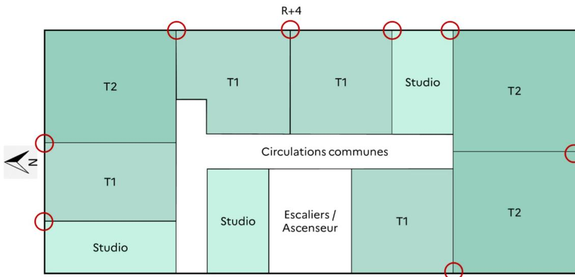
Ponts thermiques refend / mur au R+4 (Hsp = 2,5m)
