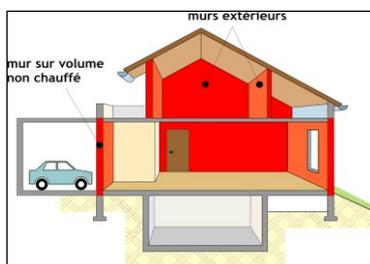
Les murs déperditifs peuvent donner sur l'extérieur, sur un local non chauffé ou sur un local tertiaire.
