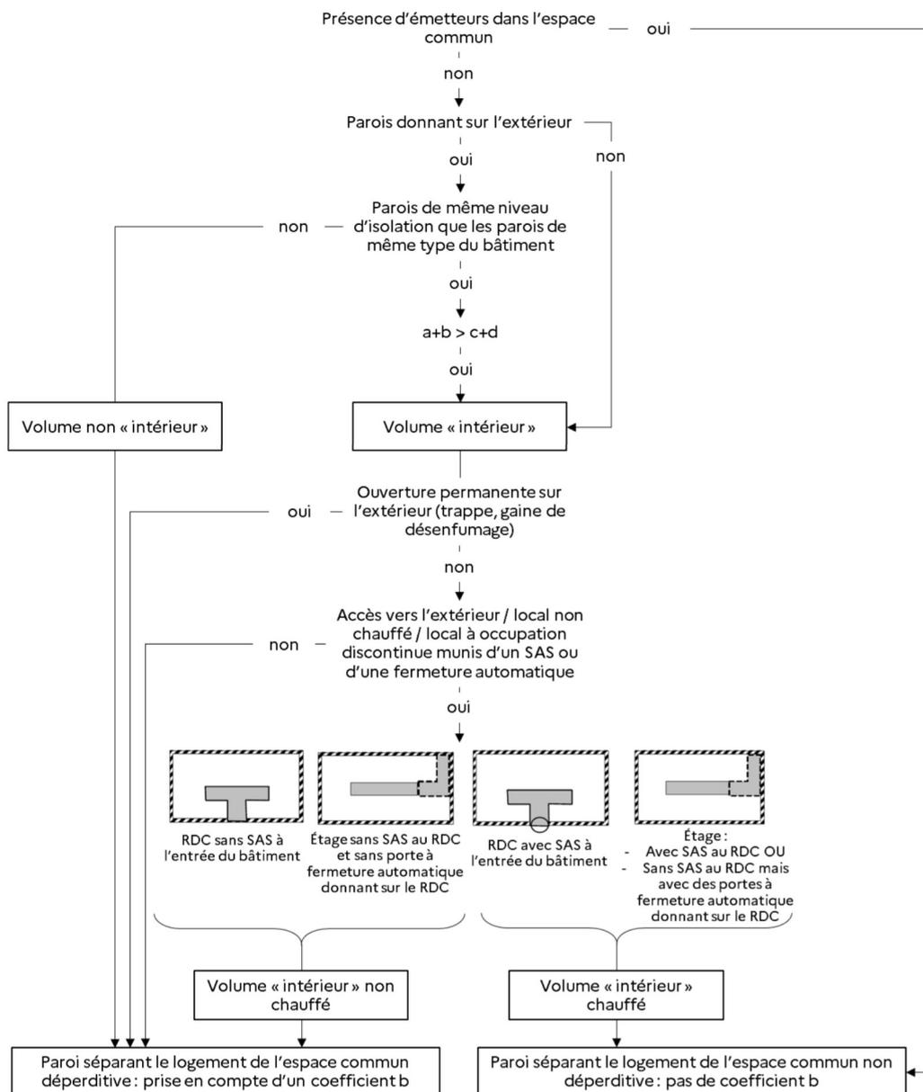
**Une paroi donnant sur un volume non intérieur ou sur un volume intérieur non chauffé sera considérée comme déperditive, et un coefficient de réduction des déperditions  $b$  devra être calculé selon la méthode détaillée ci-dessous.**
