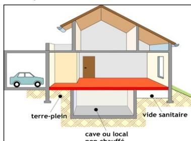
Le plancher bas peut être sur terre-plein, sur vide sanitaire, sur local chauffé ou sur local non chauffé.
