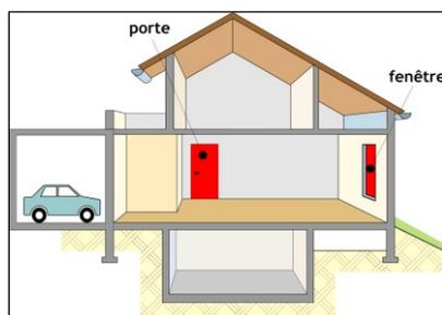
Les menuiseries concernent les fenêtres, les portes fenêtres et les portes donnant sur l'extérieur ou vers des locaux non chauffés.
